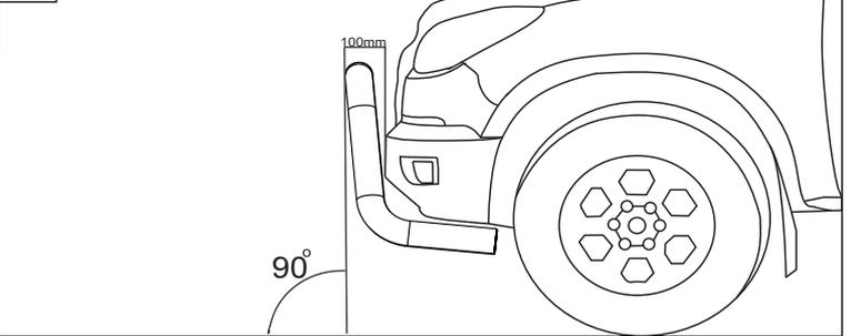
O tubo "A" deve ser fixado de modo que esteja em um ângulo de 90° em relação ao solo, conforme mostra a figura "4". O tubo não deve ultrapassar a distância máxima de 100mm do ponto mais avançado do veículo.
