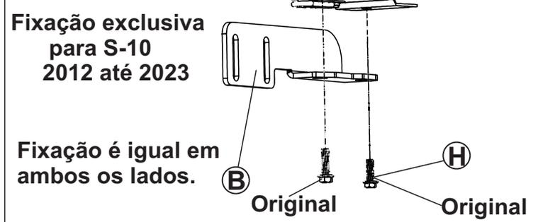
Obs: Remova os parafusos originais da travessa inferior e insira o item "B" de acordo com o ano do veículo e conforme a imagem da figura "2". Após insira os itens para fixação do suporte principal.
