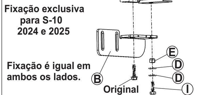
Obs: Remova o parafuso original da travessa inferior e insira o item "B" de acordo com o ano do veículo e conforme a imagem da figura "1" ou "2". Após insira os itens para fixação do suporte principal.
