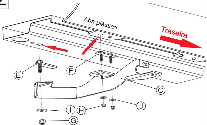
Obs: Remova os pinos plásticos da aba lateral inferior observe os pontos de fixação de acordo com o desenho da figura 2 e insira as travas no local indicado. Na aba lateral inferior puxe a aba plástica e insira o suporte entre o ponto de fixação e o plástico da aba. Após insira as porcas e arruelas deixando o suporte frouxo até o final da montagem da peça!
