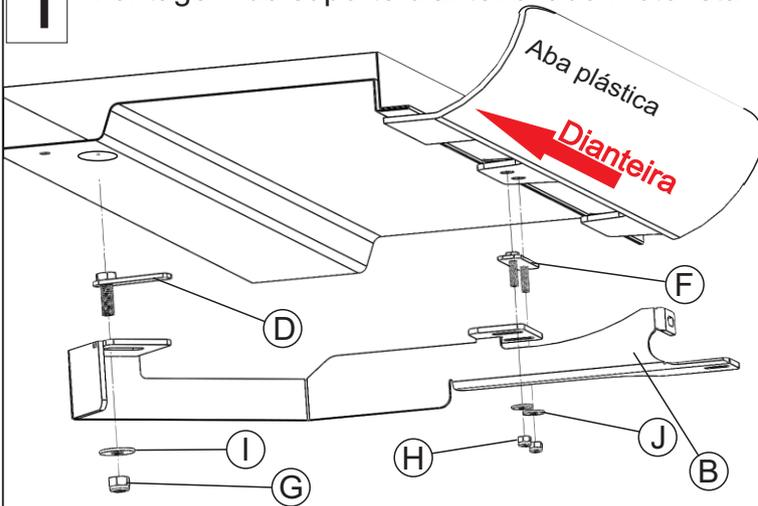
Obs: Renova os plugs plásticos da aba lateral e insira o suporte entre a aba plástica utilizando o item "F", prenda a aba sobre o suporte de fixação deixando-o frouxo. Insira o item "D" e também deixe-o frouxo até a montagem do estribo sobre os suportes instalados! Após a montagem do quadro 3 dê aperto a todos os itens!
