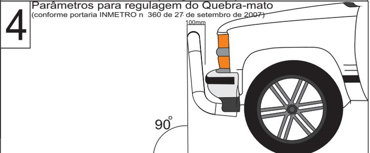
O tubo "A" deve ser fixado de modo que esteja em um ângulo de 90° em relação ao solo, conforme mostra a figura "6". O tubo não deve ultrapassar a distância máxima de 100 mm do ponto mais avançado do veículo.
