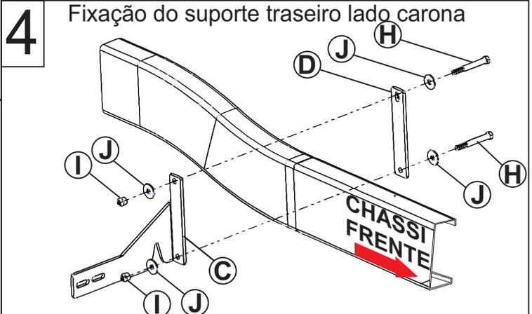
Após inserir todos os itens deixe-os para regulagem final a ponto de movelos com as mãos para cima ou para baixo.
