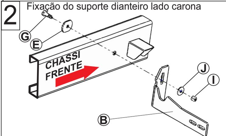
Após inserir todos os itens deixe-os para regulagem final a ponto de movelos com as mãos para cima ou para baixo.
