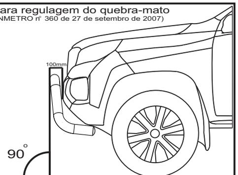
O tubo "A" deve ser fixado de modo que esteja em um ângulo de 90° em relação ao solo, conforme mostra a figura "5", o tubo não deve ultrapassar a distância máxima de 100 mm do ponto mais avançado do veículo.
