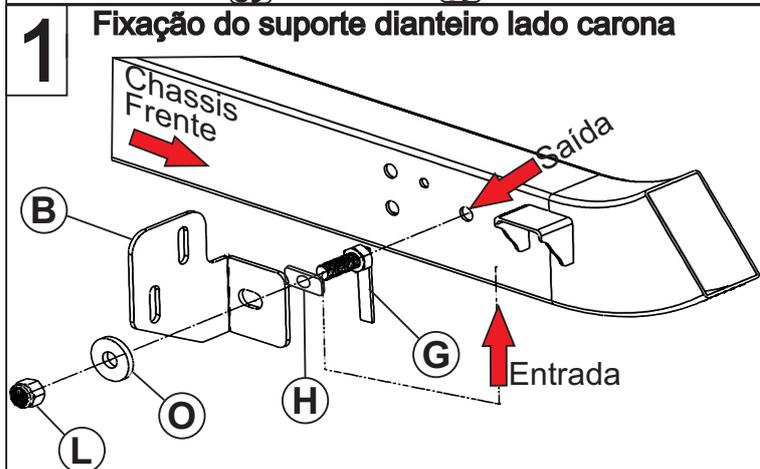
Obs: O item "G" deve ser inserido no furo inferior do chassi na parte de baixo, conforme a seta do quadro (1). Deve sair na lateral do chassi conforme figura (1)
