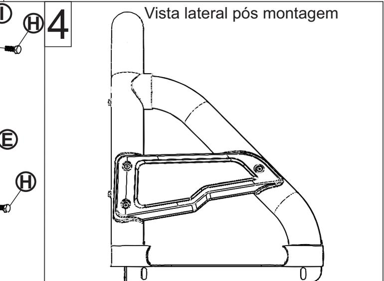
Obs: Após a montagem do quadro 1 aplique os itens "D", "E", "I" e "H", fixando assim as bases. Deixe-as frouxas até a fixação na caçamba do veículo.
